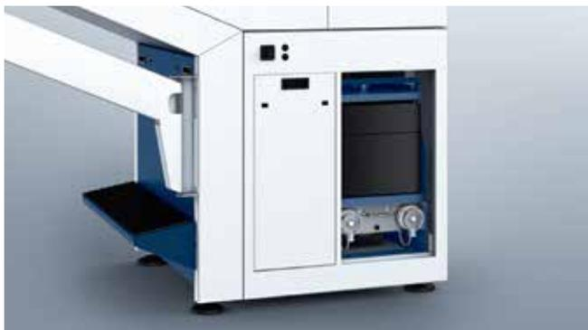
集成的吸尘器可保护员工免受烟雾和颗粒物的侵害。
