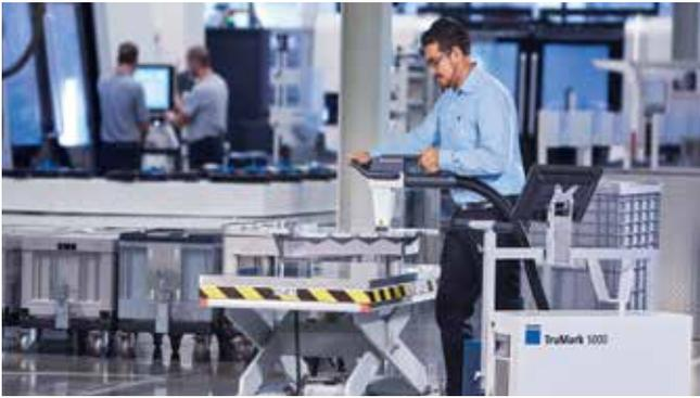
使用 TruMark 5010 移动打标机，您可以舒适安全地标记大型和重型金属部件。
