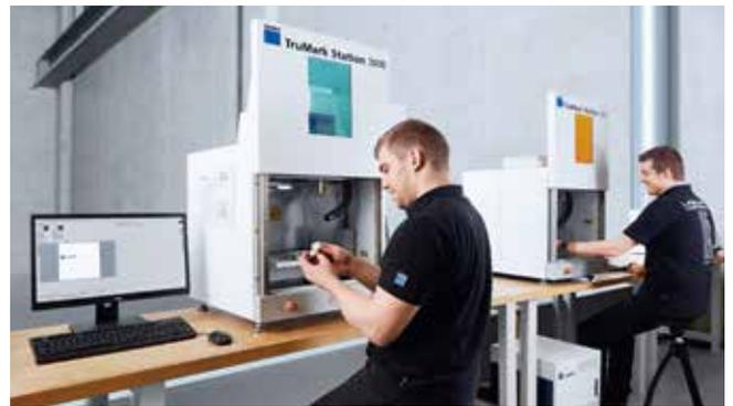
您还可以将 TruMark Station 3000 用作桌面工作区或作为独立解决方案——将电机柜和吸尘器集成到底部结构中。
