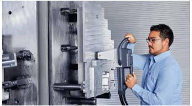
只需在您需要的任何地方使用风冷的移动式激光打标机。这有助于减少进出工作站的非生产时间和运输工作量。
