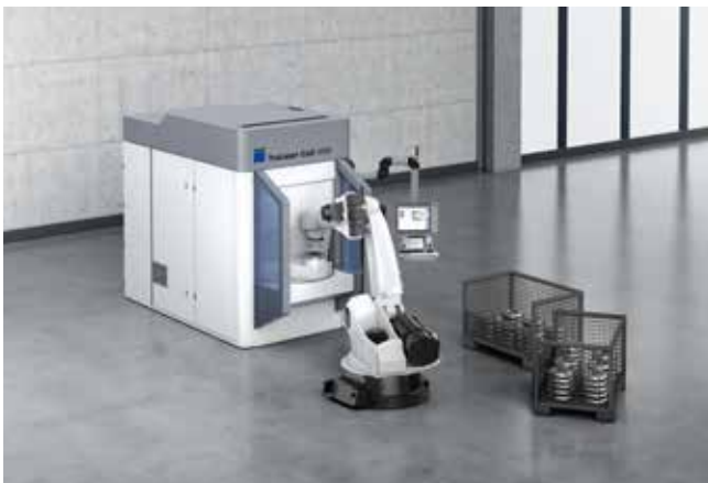
TruLaser Cell 3000 和机器人配合可以轻松上下料。
