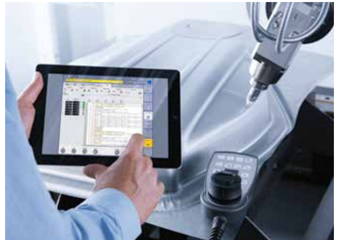
使用 MobileControl 功能和示教器可直接根据工件快速创建程序。
