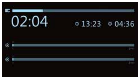
剩余时间显示可帮助您快速了解零件以至整个订单的加工情况。
